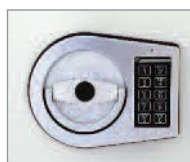
Cerradura Electrónica con certificación según la norma Europea ENV 1300 grado 2 VDS. 1 millón de combinaciones posibles, 1 código maestro y 1 código de usuario programables. Sistema alimentado por una pila de 9V accesible desde el exterior.
