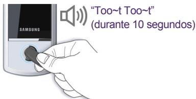
Esta alarma sonará si hay un intento de abrir la puerta con una llave táctil no válida, o si se introduce una combinación incorrecta tres veces seguidas.
