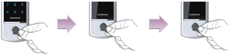
Para registrar múltiples llaves táctiles, presione ligeramente otra llave táctil sobre el contacto dentro de 10 segundos después de haber registrado la primera llave táctil. Si otra llave táctil no es expuesta al contacto dentro de los 10 segundos, el proceso de registro finalizará automáticamente.
