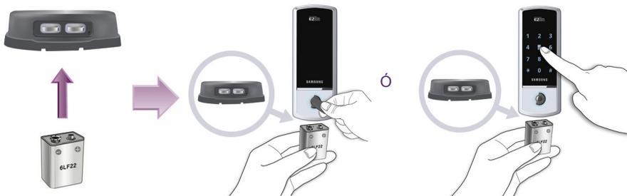
Coloque la llave táctil sobre el botón de contacto o introduzca la combinación mientras la batería de 9V está conectada al contacto del alimentador externo de la unidad exterior.
