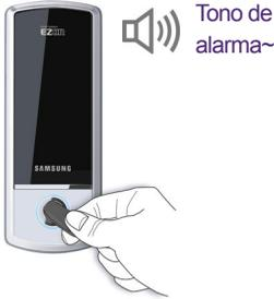
Si la alarma suena como un 'Toot~' cuando se abre la puerta utilizando la combinación o la llave táctil, es hora de cambiar las baterías.
