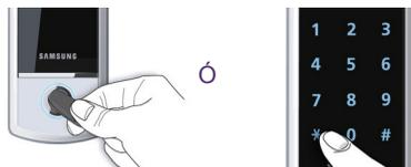
Colocar la llave táctil sobre el contacto, o introducir la combinación y luego presionar el **botón [\*]**.
