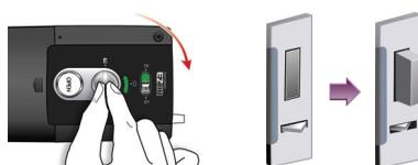
Girar el pomo palanca Apertura/Cierre manual en sentido de las agujas del reloj cuando la puerta esté cerrada en el modo de cierre manual.
