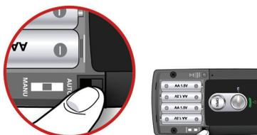
Seleccionar el interruptor de cierre automático /manual de la unidad interior en la posición de "auto".
