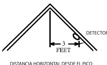
Figura 5: SITUACIÓN RECOMENDADA PARA INSTALAR LOS DETECTORES EN TECHOS CON PENDIENTE O A DOS AGUAS
