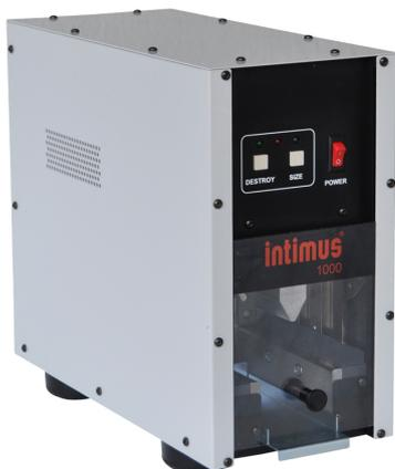
El intimus® 1000 destruye físicamente el disco duro por plegado, rompe y separa todos sus componentes. Los discos son doblados y separados del centro, las carcasas son inutilizadas y el PCB están rotos. El intimus® 1000 destruye todo tipo de discos duros sin importar el tamaño, sistema operativo o interfaz. Con el sistema automático de detección de altura, es capaz de destruir varios dispositivos de una sola vez.
